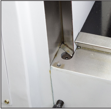
Figure 4-14 Knee (Z axis) gib, topside
